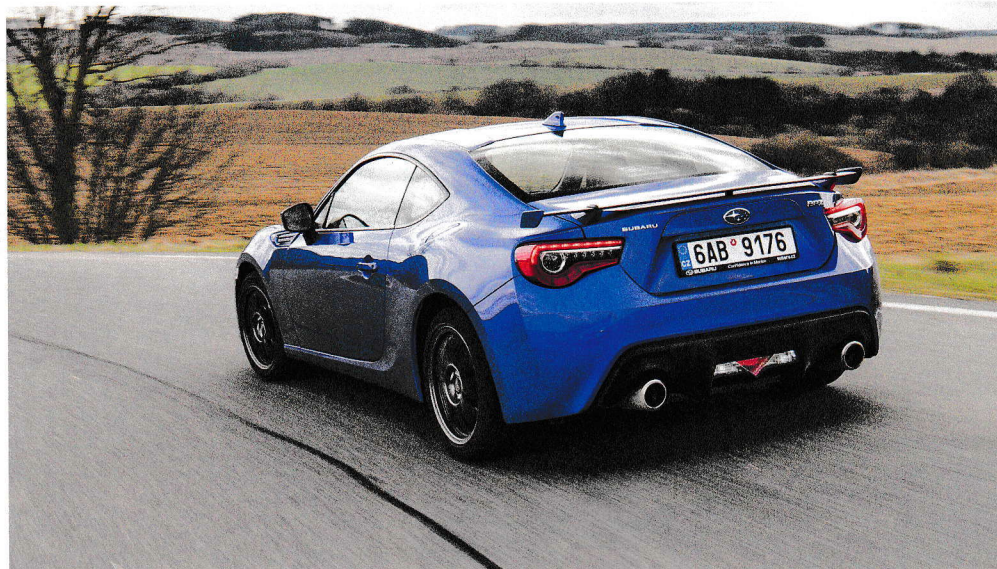
Zadní spoiler již nemá podobu odtrhové hrany, ale vzduch ho obtéká i zespoda
