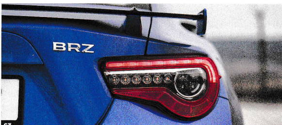
Zadní skupinové svítlny jsou kompletně tvořeny zdroji LED, při nouzovém brzdění se nově rozblíkájí
