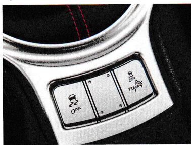
Stabilizační systém VDC má tři režimy (zapnuto, Track a vypnuto) a vyznačuje se mnohem lepším naladěním
