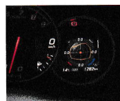
V hlavních přístrojích je umístěn displej, zobrazující kromě rychlosti také teploty chladicí kapaliny a oleje, zrychlení (na fotografii), data palubního počítače a další informace
