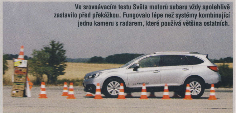
Výrobce deklaruje samočinné brzdění do 50 km/h. Funguje to ale ještě při skutečných 55 km/h.
