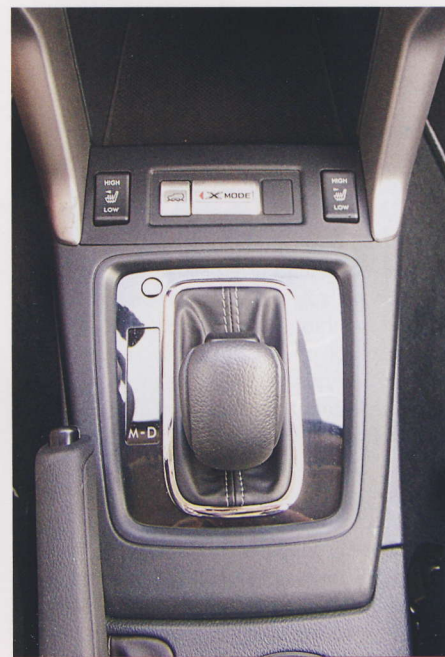
Volič převodovky CVT umožňuje i manuální řazení
