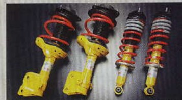
Tlumiče od Bilsteinu s péry STI mají lvi podíl na schopnějším podvozku. Aby ne, sada vyšla na 87 444 Kč.
