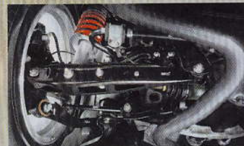
Pevné unibalové uložení zadních ramen lépe vede kola v zatáčkách a stará se o citelnější jízdní projev
