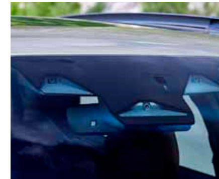
Nejnovější generace systému EyeSight pracuje se třemi kamerami a čtyřmi radary, rozpoznává i chodce a jednostopá vozidla na křižovatkách
