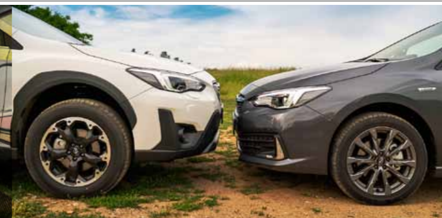
Impreza má o celých 80 mm nižší světlou výšku a její kola mají o 56 mm menší průměr. Impreza je proto sportovnější na hladkém povrchu, zatímco XV si poradí i s překvapivě náročným terénem
