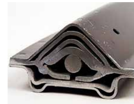
Průřez masivním A-sloupkem jednoho z modelů Subaru postavených na platformě SGP
