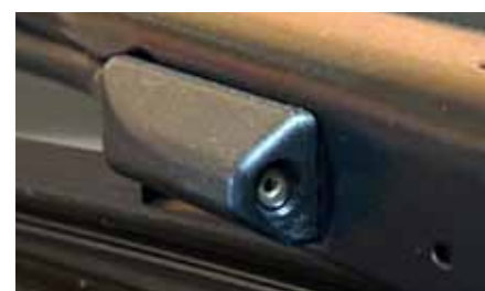
Tryska ostřikovače umístěná přímo na ramínku pravého stěrače zajistí lepší omytí čelního okna
