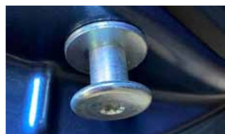
Tyto kolíčky ve spodní části dveří při nárazu z boku dveře s karoserií a celek propojí
