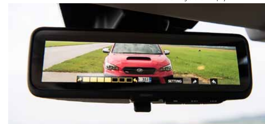
Digitální zpětné zrcátko zobrazuje prostor za vozem na integrovaném displeji
