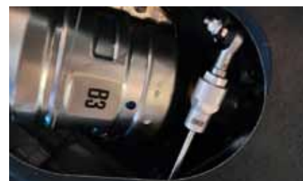
U STI přesně vědí, kde BRZ vyztužit. Zde šikmá spojka mezi nápravnicí a karoserií
