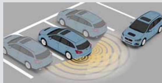
Radarová židla v zadním nárazníku hlídají mrtvé úhly zpětných zrcátek a současně varují při vycouvávání z parkovacího místa na příčné se blízcí automobily
