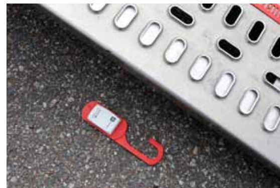
Každý vůz má speciální čip s veškerými informacemi o objednavce, výrobě i expedici. Na přístavním parkovišti to zefektivňuje jeho evidenci a pohyb. Lokace auta je naprosto pod dohledem
