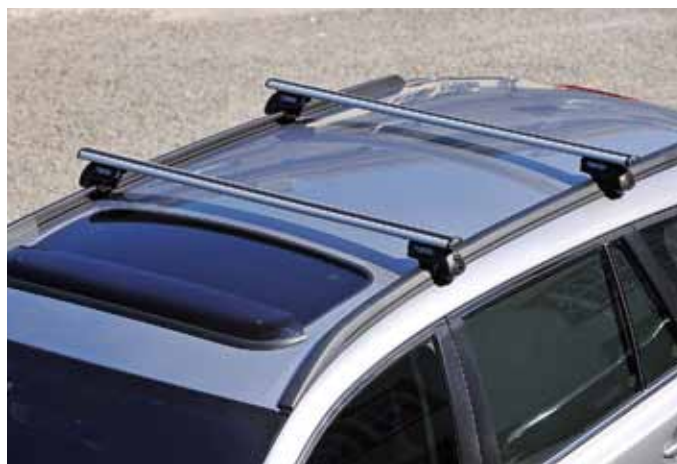
◆ Nevyužívaný střešní nosič může při jízdě po dálnici zvýšit spotřebu až o litr na 100 km
