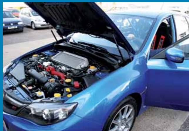
Pod kapotou vozu je plochý přeplňovaný čtyřválec s protiběžnými písty
