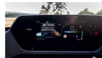
Uživatelské rozhraní Solterra je v principu tvořeno dvojicí displejů. Ten přístrojový (vlevo) je umístěn vysoko nad palubní deskou a současně pod spodním okrajem čelního skla – přirozeně tak nahrazuje head-up displej. Hlavní displej navigace (vpravo) má úhlopříčku 12,3", jemnou grafiku a nabízí všechny obvyklé funkce infotainmentu a konektivity
