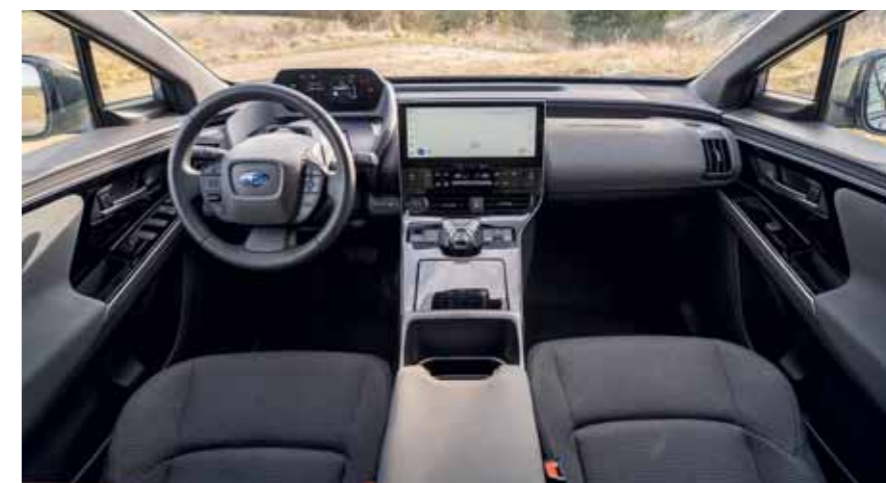
Uživatelské rozhraní Solterra je v principu tvořeno dvojicí displejů. Ten přístrojový (vlevo) je umístěn vysoko nad palubní deskou a současně pod spodním okrajem čelního skla – přirozeně tak nahrazuje head-up displej. Hlavní displej navigace (vpravo) má úhlopříčku 12,3", jemnou grafiku a nabízí všechny obvyklé funkce infotainmentu a konektivity
