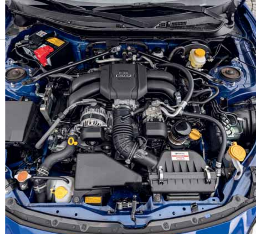
Motor dostal o 20 % větší objem, který mu přinesl více výkonu i točivého momentu. Současně motor získal větší chuť po otáčkách. Jde o velký posun vpřed
