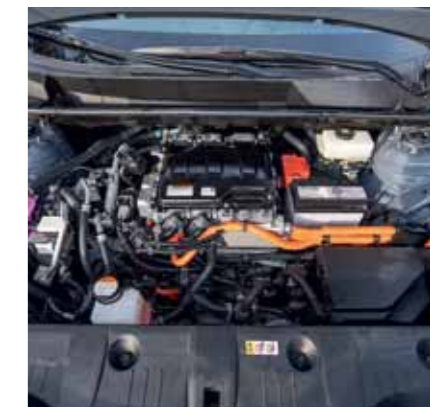
Nad předním motorem je výkonová elektronika, která se stará o přípravu proudu putujícího k elektromotorům
