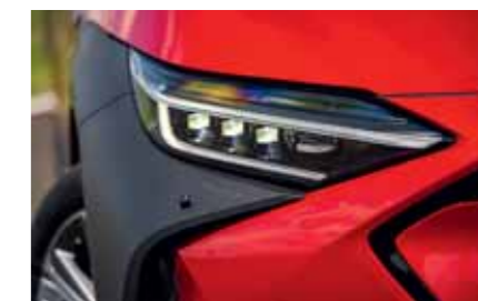
Samozřejmostí jsou adaptivní LED světlomety šetřící energii se schopností automaticky regulovat činnost dálkových světel
