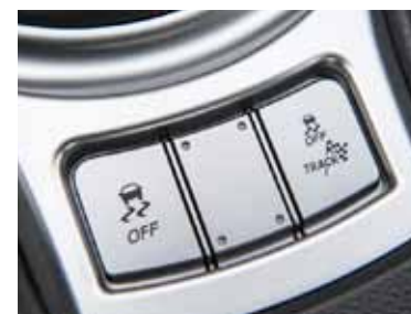
Nejdůležitější spínač interiéru: vypnutí stabilizace (vlevo). Vpravo se aktivuje nový režim Track s velmi dobrým nastavením pro začátečníky
