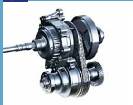
Součástí převodovky Lineartronic je také spojka rozdělující hnací sílu mezi přední a zadní nápravu
