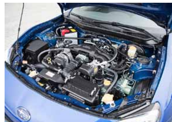
Motor je hluboko zapuštěný mezi předními koly. Tím přispívá k optimálnímu rozložení hmotnosti i nízkému těžišti (jen 46 cm nad zemí)
