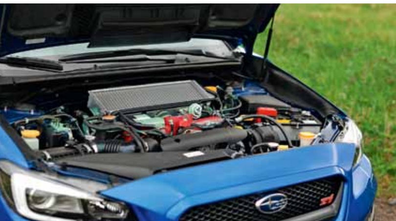
Subaru se také u nového WRX STI drží osvědčeného přístupu s nízkým a krátkým motorem Boxer
