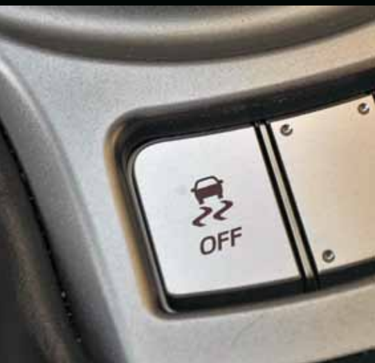
U Subaru BRZ je ze zřejmých důvodů tlačítko pro vypnutí stabilizačního systému ideálně po ruce těsně před řadicí pákou...
