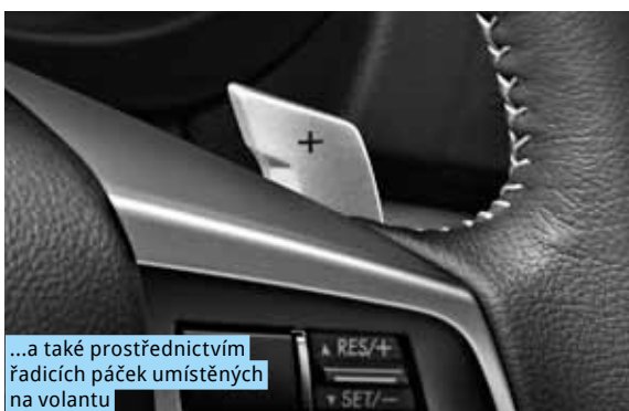
Převodovka umožňuje i sekvenční řazení předprogramovaných 6 nebo 8 převodových poměrů pomocí voliče...
