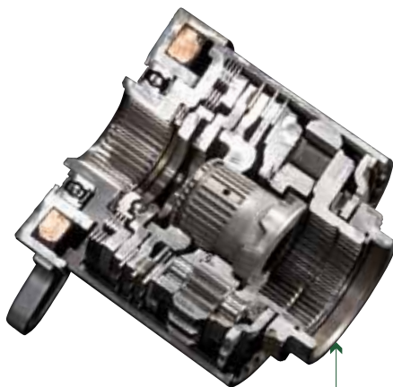
Aktivní mezinápravový diferenciál DCCD modelů WRX STI mění svornost pomocí elektromagneticky řízené lamelové spojky
