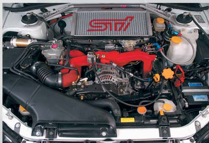
Subaru Impreza STI Spec C pohání dvoulitrový přeplňovaný motor
